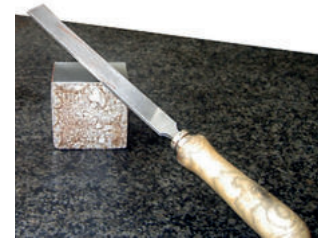
Fig. 8 Sbavatura della superficie 1.
