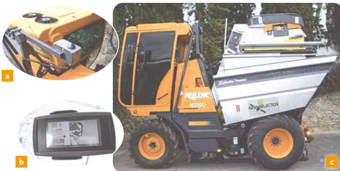
Figura 6.73. (a) Particolare del GNSS; (b) visualizzazione della mappa di prescrizione e dell'andamento della raccolta sul monitor di bordo; (c) vista complessiva della vendemmiatrice VRT.
