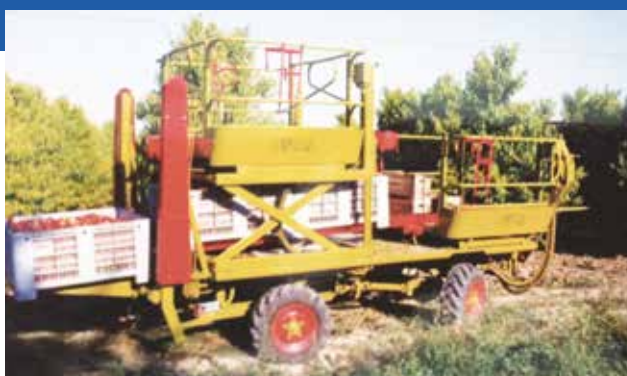
Figura 6.49. Sui carri semoventi per la raccolta della frutta già da anni sono stati dimostrati i vantaggi che derivano dall'uso della trazione elettrica in sostituzione di quella meccanica.
