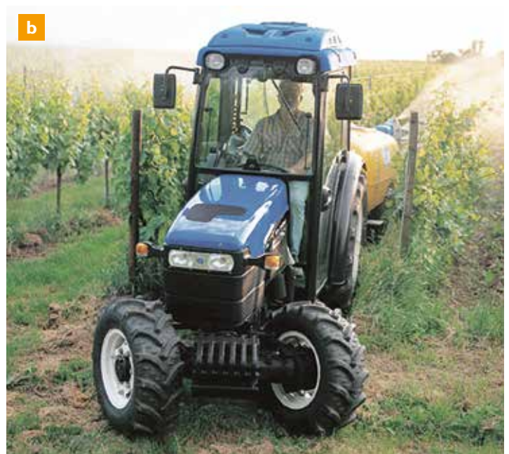
Figura 6.36. (a) Schema di funzionamento dell'idroguida. (b) Trattore speciale da vigneto con angolo di sterzata elevato.
