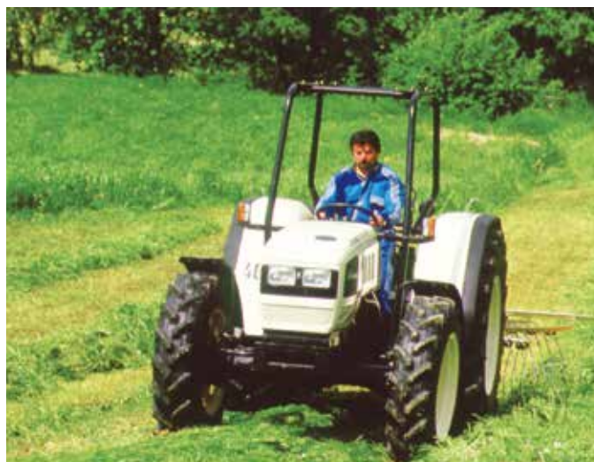
Figura 6.42. Trattore di media potenza con telaio di sicurezza senza cabina.
