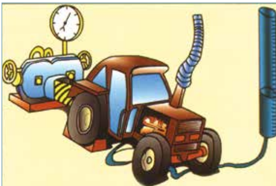
Figura 6.18. Rappresentazione concettuale di come viene eseguita la prova al freno dinamometrico di un motore Diesel montato su un trattore.
