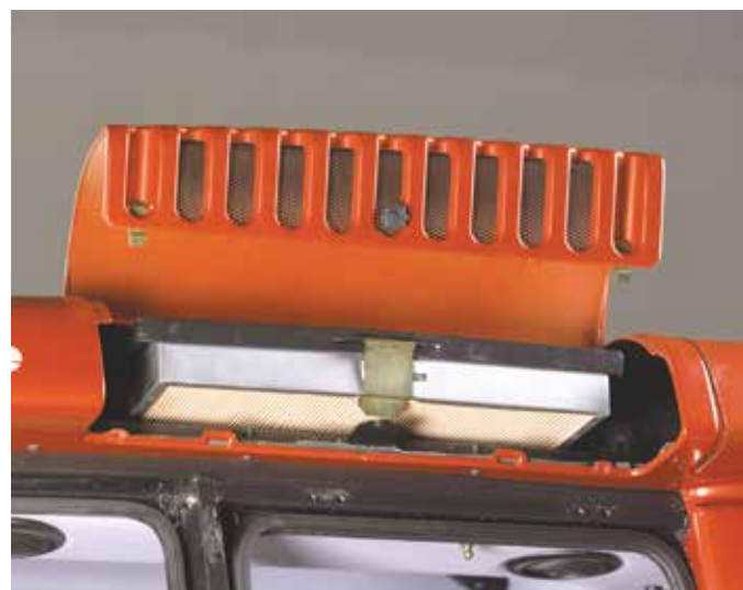
Figura 6.50. Sistema di filtraggio dell'aria da inviare in cabina.
