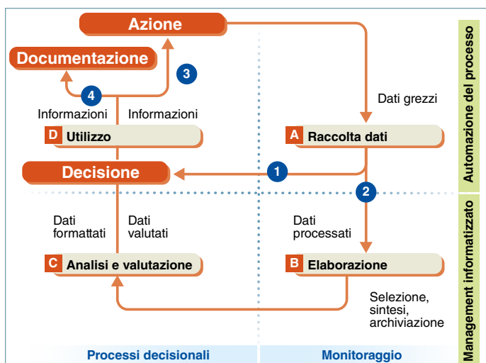
Figura 6.58. Struttura dei SIA, in evidenza il ciclo di trasformazione dei dati grezzi in informazioni. È opportuno distinguere le fasi relative alle attività di monitoraggio (raccolta dati ed elaborazione dei dati) da quelle connesse ai processi decisionali (analisi, valutazione e utilizzo dei dati).
