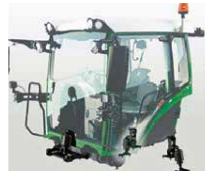
Figura 6.53. Cabina isolata dal telaio mediante sospensioni pneumatiche.
