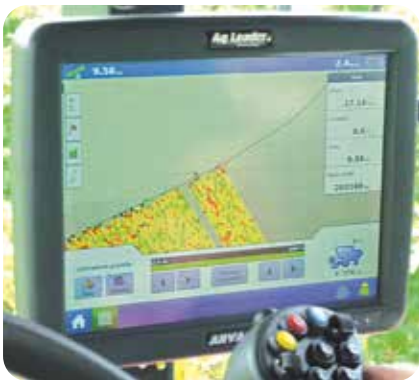
Figura 6.69. Esempio di prima elaborazione sul monitor della vendemmiatrice dei dati di raccolta.
